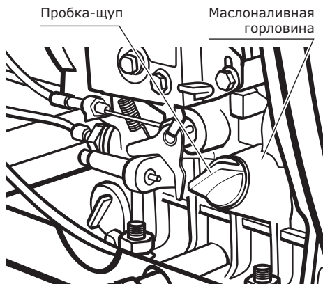
Рис. 7. Заполнение масляного картера и контроль уровня масла.
