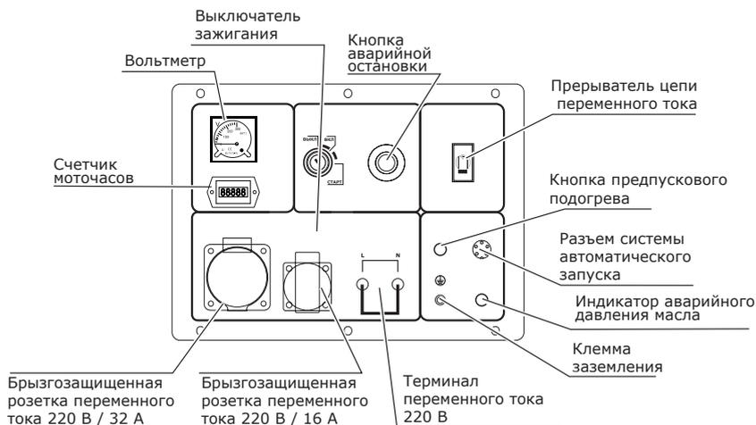
**Схема панели управления генераторов УГД-12000ЕТ PROFF, УГД-15000ЕТ PROFF.**
