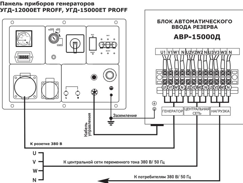
**Рис. 20. Схема подключения блока АВР-15000Д и однофазного генератора на 220 В к трехфазной сети.**
