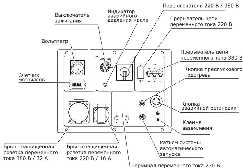
**Рис. 5. Общий вид генератора УГСД-4000/180E PROFF.**
