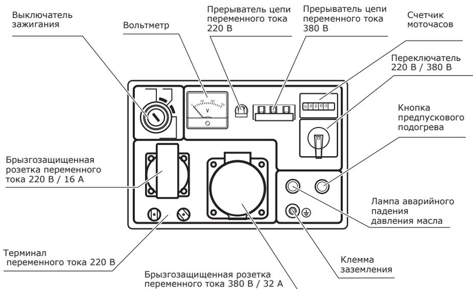
**Схема панели управления генераторов УГД-9500ЕТ PROFF, УГД-11000ЕТ PROFF.**
