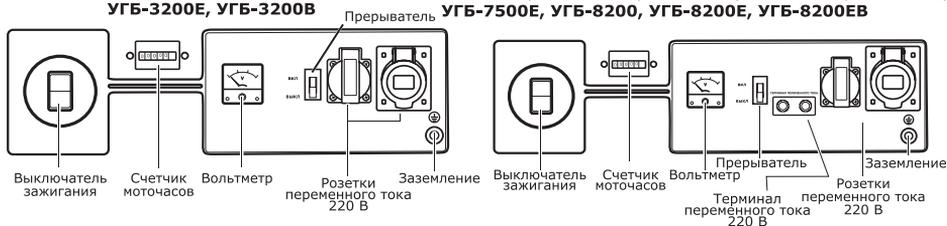
\* - УГБ-2000, УГБ-2500, УГБ-3200, УГБ-3200Е применяется одна розетка на 16 А; на моделях УГБ-4000, УГБ-4000Е, УГБ-5000, УГБ-5000Е - две розетки на 16 А; на моделях УГБ-3200В, УГБ-7500, УГБ-7500Е, УГБ-8200, УГБ-8200Е, - одна розетка на 16 А, одна на 32 А; на модели УГБ-8200ЕВ - одна розетка на 16 А, одна на 32 А и терминал переменного тока.
