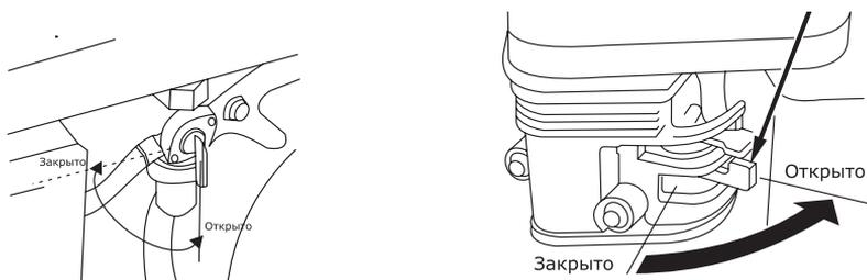
**ВНИМАНИЕ!** Управление топливным краном на разных моделях бензиновых генераторов СКАТ отличается. Смотрите рисунки.
