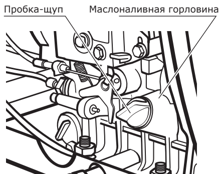
Рис. 2 Заполнение масляного картера
