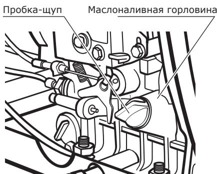
Рис. 2 Заполнение масляного картера
