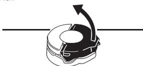
*Прокрутите на 1/4 оборота против часовой стрелки крышку топливного бака.*
