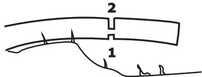
1. Запилите разгрузочный рез со стороны действия сил сжатия (1).
