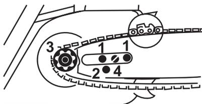
Фиксирующее отверстие (2) положите на цапфу прижимной задвижки – одновременно пильную цепь положите на звездочку цепи (3).
