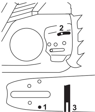
Измерьте глубину паза (3), – с помощью мерной линейки. Допустимая минимальная глубина паза = 5 мм.
