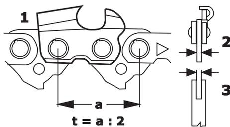
Шаг (t) пильной цепи (1), цепной звездочки и концевой звездочки направляющей шины должен совпадать.
