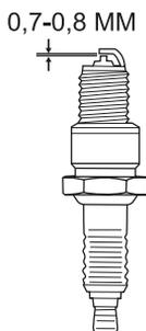
4. Установите свечу зажигания в двигатель и надежно затяните. Недостаточная затяжка свечи зажигания может привести к ее перегреву и повреждению двигателя.
