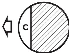
Подпил (C) определяет направление валки дерева. Выполняйте следующие действия:
