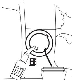
3. Отсоедините топливный фильтр от топливного шланга. Придерживайте при этом топливный шланг, во избежание его возвращения в топливный бак.
