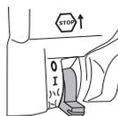
Поверните фиксатор кожуха (1) против часовой стрелки на ¼ оборота.
