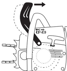
**ВНИМАНИЕ!** Прежде чем давать газ (исключение при контроле работы) и перед пилением необходимо отпустить тормоз пильной цепи. Повышенная частота вращения мотора при заблокированном тормозе цепи (пильная цепь неподвижна) уже через короткое время ведет к повреждению приводного механизма и привода пильной цепи (сцепления, тормоза цепи).
