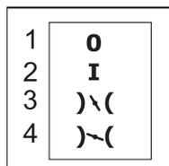
Для перевода комбинированного рычага с рабочего положения 2 в положение 4, зажмите и удерживайте одновременно рычаг блокировки газа и рычаг газа.
