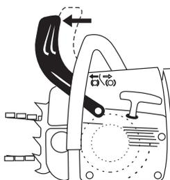
Для разблокировки тормоза пильной цепи, потяните защитный щиток к трубчатой рукоятке.
