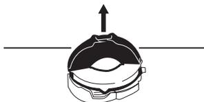
4. Убедитесь в наличии и исправности топливного фильтра в баке. Для этого вытяните фильтр на топливном шланге из бака.
