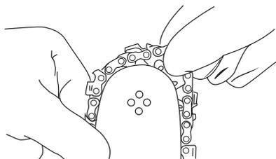
5. Направляющую шину наложите на болты (1) – режущие края пильной цепи должны указывать вправо.
