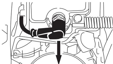
3. Выверните свечу зажигания свечным шестигранным ключом, входящим в комплект поставки, и осмотрите свечу. Электроды свечи должны иметь светло-коричневый цвет.
