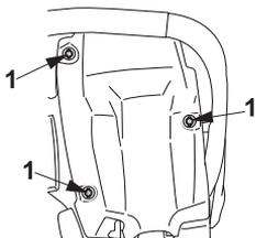
3. Окружение фильтра очистите от грубой грязи. Для демонтажа и монтажа воздушного фильтра не применяйте какие-либо инструменты – воздушный фильтр можно повредить. Фильтр снимите.
