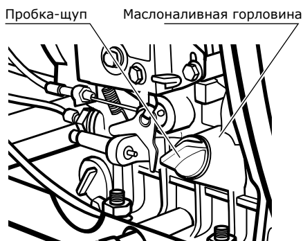
Рис. 2 Заполнение масляного картера
